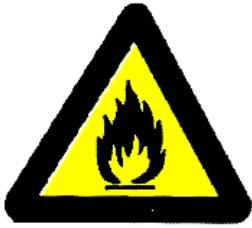
Εύφλεκτες ύλες ή υψηλή θερμοκρασία
